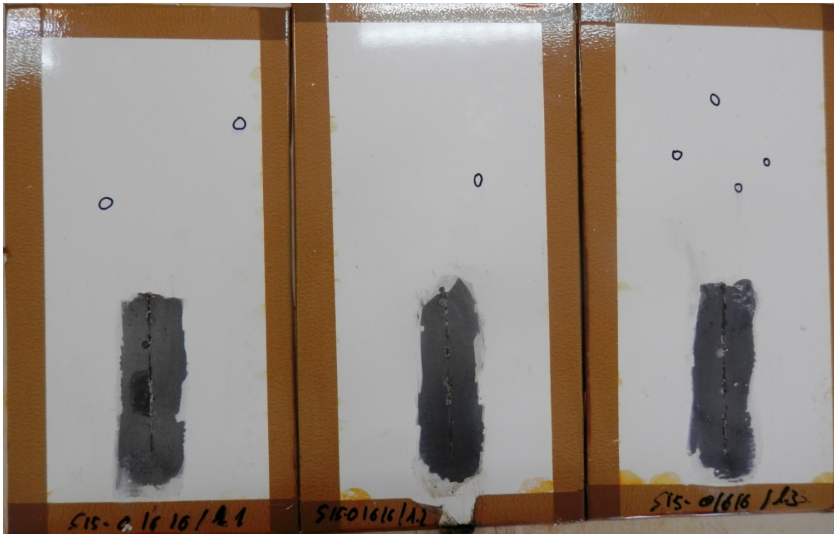
Avance de la corrosión a partir de la incisión (tras decapado en laboratorio)
